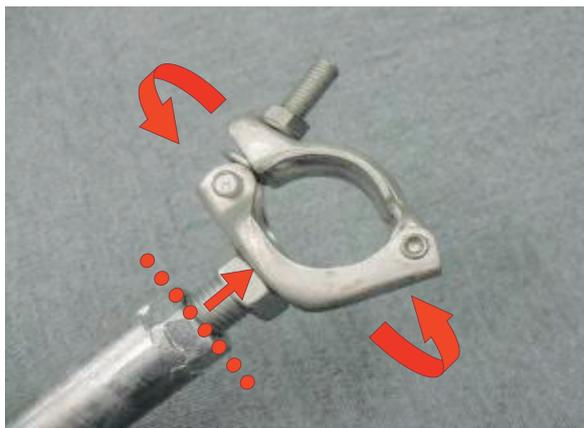
杭への取付前クランプを回転させます。伸び最大はボルト頭(赤線点線部)から15mmです。
